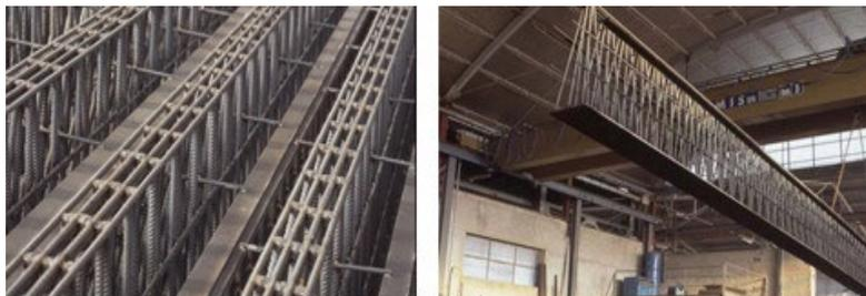
La Trave Reticolare SER resiste a carichi elevati per l'evoluta concezione ingegneristica: il basso spessore, pari a quello del solaio, consente una migliore progettualità degli ambienti per l'assenza della classiche travi "a pendere" e, in abbinamento con i solai leggeri in polistirene, realizza luci di campate elevate, migliorando la fruizione degli spazi interni.
