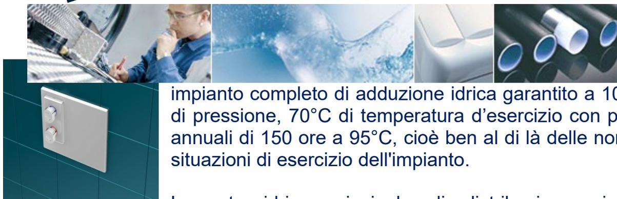
impianto completo di adduzione idrica garantito a 10 bar di pressione, 70°C di temperatura d'esercizio con picchi annuali di 150 ore a 95°C, cioè ben al di là delle normali situazioni di esercizio dell'impianto.
