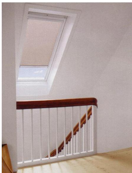
Nella falda di copertura dei vani scala di ciascuna unità immobiliare sarà collocato un lucernario realizzato con una finestra "solare" a vasistas Relux, con apertura elettrica motorizzata tramite telecomando a distanza, alimentata da batteria solare incorporata, con chiusura automatica in caso di pioggia, con anta avente struttura in legno rivestita di poliuretano verniciato di colore bianco, che non richiede alcuna manutenzione, completa di vetrata isolante a bassa emissività.
